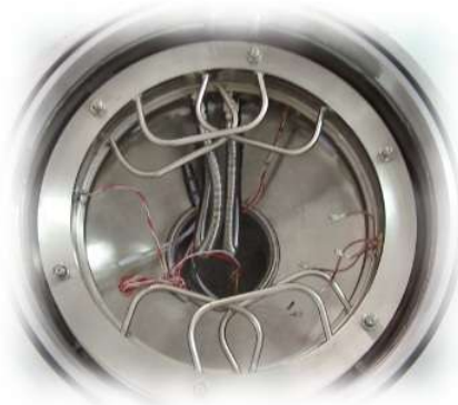
Base de cámara de sputtering hecha a medida.
