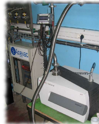
Sistema espectroscópico para la detección de fugas
