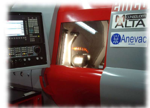
Nuestras piezas de vacío están mecanizadas por control numérico hasta una precisión de \pm 0,03 mm
