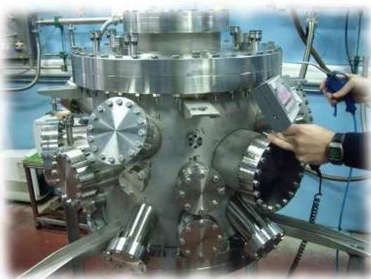
Comprobando la estanqueidad de una cámara UHV
